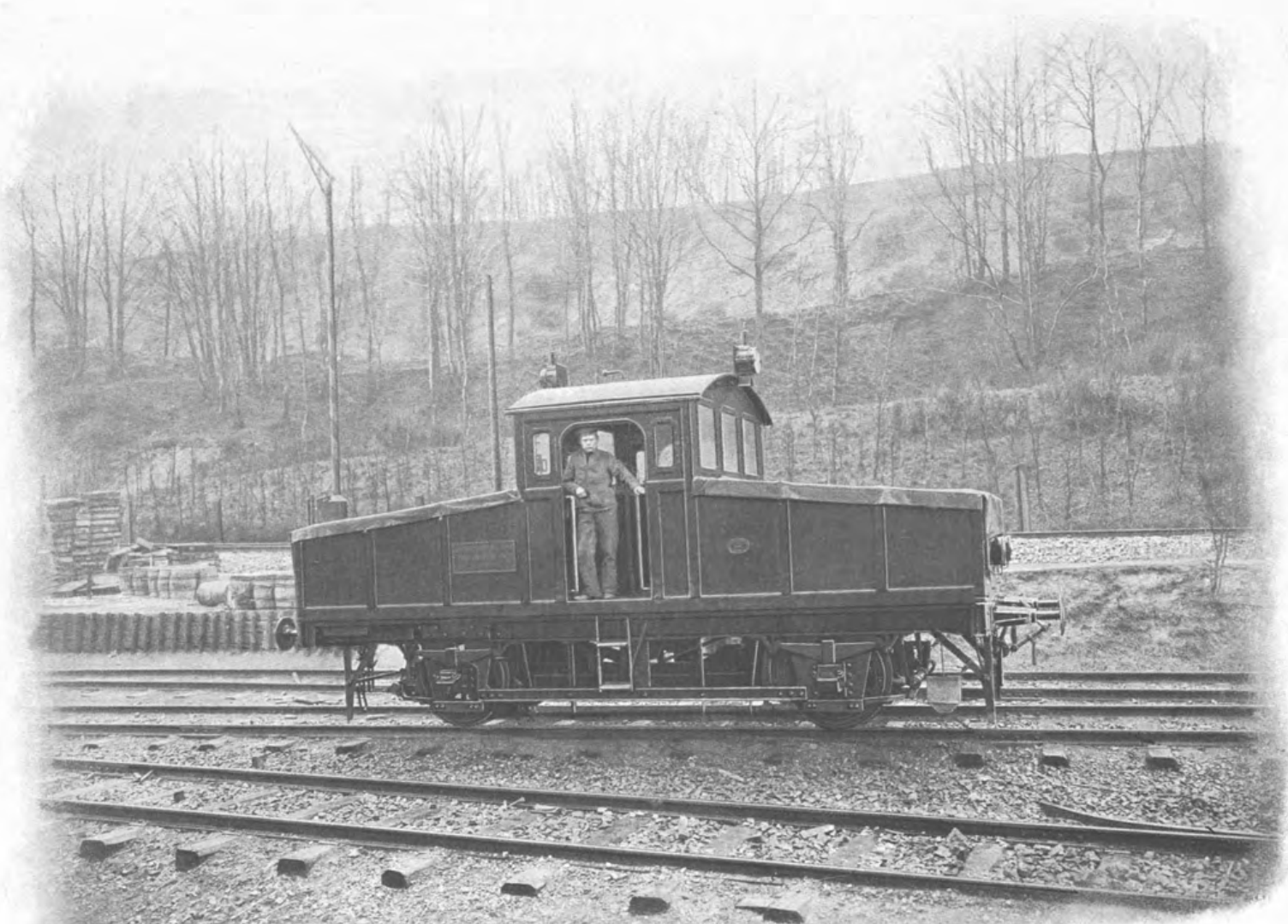
HAGEN i. W. Akkumulatoren-Fabrik-Aktiengesellschaft. Akkumulatoren-Lokomotive für den Dienst auf den Fabrik-Anschlussgleisen Locomotive avec accumulateurs employée sur l'embranchement conduisant à la fabrique Locomotive with Storage-battery on the Branch Line of the Factory.
