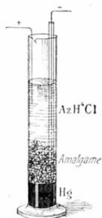
Fig. 304. — Électrolyse du chlorure d'ammonium en dissolution.
