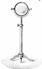
Fig. 127. — Lentille destinée aux expériences de cours.
