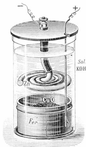
Fig. 294. — Élément de Lalande et Chaperon.
