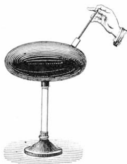
Fig. 230. — Étude de la distribution sur un conducteur ellipsoïde.
