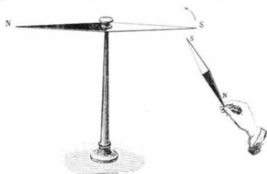
Fig. 316. — Actions mutuelles des pôles de deux aiguilles aimantées.
