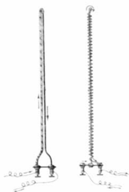
Fig. 349. — Disposition employée pour montrer les actions d'un courant droit et d'un courant sinueux.
