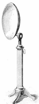
Fig. 71. — Miroir métallique et son support.
