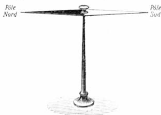
Fig. 315. — Orientation d'une aiguille aimantée mobile dans un plan horizontal.
