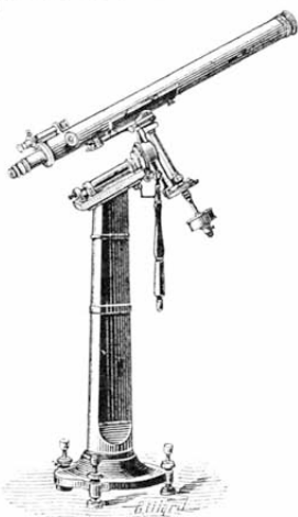
Fig. 171. — Lunette équatoriale d'Observatoires.
