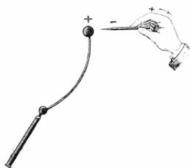
Fig. 276. — Expérience montrant le mode d'action d'un paratonnerre.
