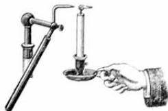
Fig. 231. — Expérience montrant l'écoulement de l'électricité par une pointe.
