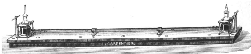
Fig. 54. — Copie d'un étalon prototype en mercure.
